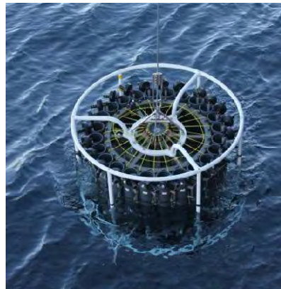
Testeinsätze der CTD/Rosette (links) und des Pump-CTD-Systems (rechts) (Foto: I. Schuffenhauer)
