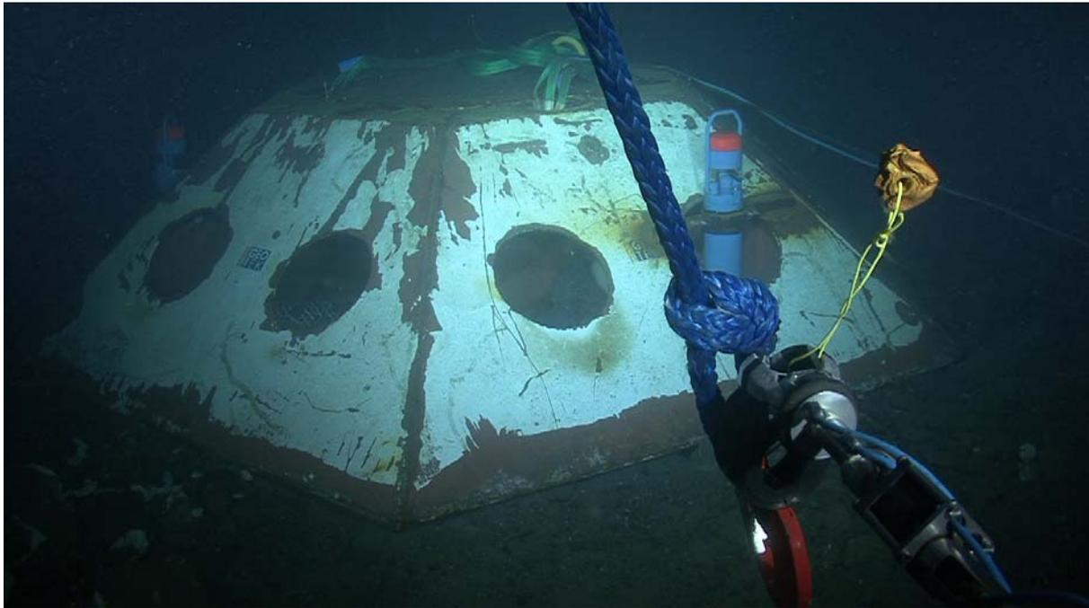
**Abbildung 1: Im Vordergrund ist der Manipulatorarm von Jago zu sehen. Im Hintergrund steht das Observatorium mit verschiedenen Sensoren (Bild: Jago Team) noch auf dem Meeresboden.**
