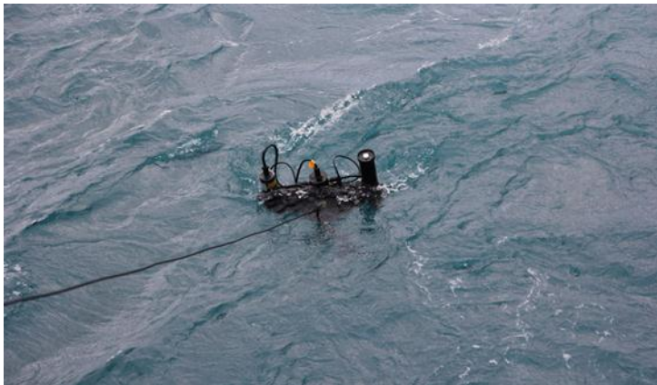
Ausbringen des Satlantic radiometrischen Profilers im Vaigat an der Westküste Grönlands (Foto: Oliver Zielinski, ICBM, Universität Oldenburg)
