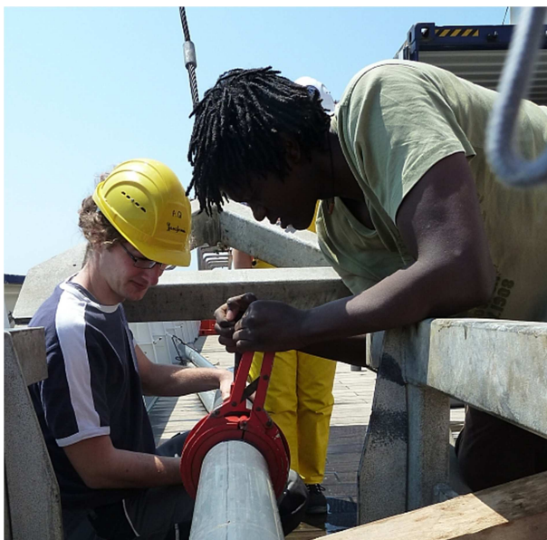
Segmentierung eines Sedimentkerns
