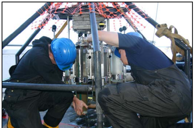
Andreas Neumann und Markus Ankele entnehmen aus dem Multicorer eine Sedimentprobe vom Meeresgrund.
