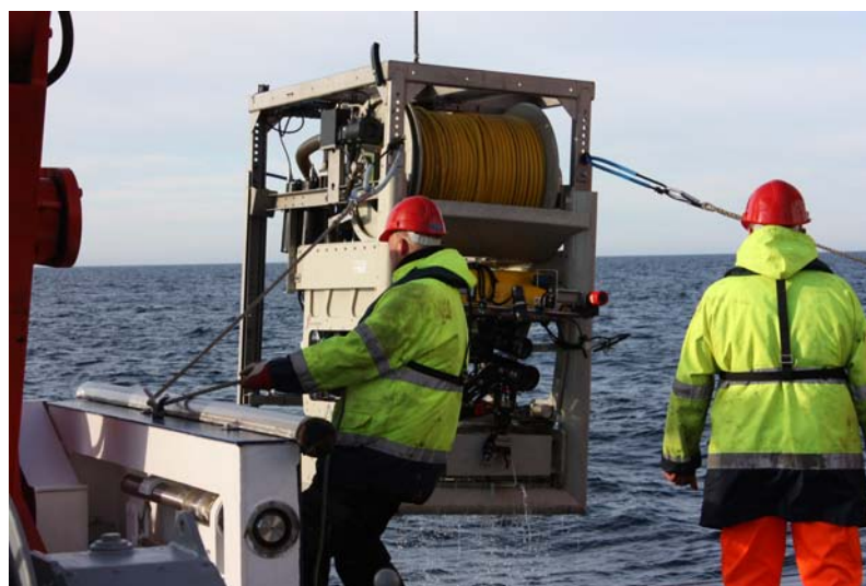
Das ROV Genesis wird in seinem TMS-Käfig geborgen. Foto: V. Asendorf
