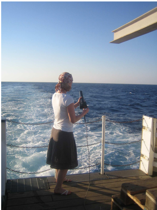
Abb. 2) Links: Schießen eines XBTs. Rechts: Abfüllen von Wasserproben aus den Schöpfern der CTD-Rosette
