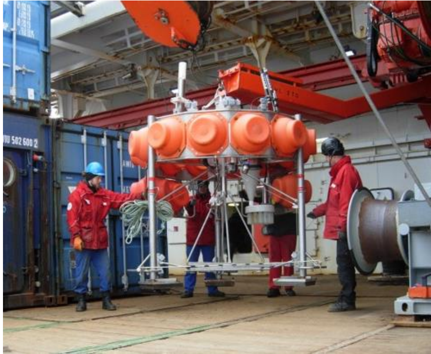
Abb. 11 Ausbringung eines Langzeitfreifallgeräts mit Sinkstofffalle, Strömungsmesser, O 2 -Optoden und Zeitrafferkamera für einen 12-monatigen Einsatz.
