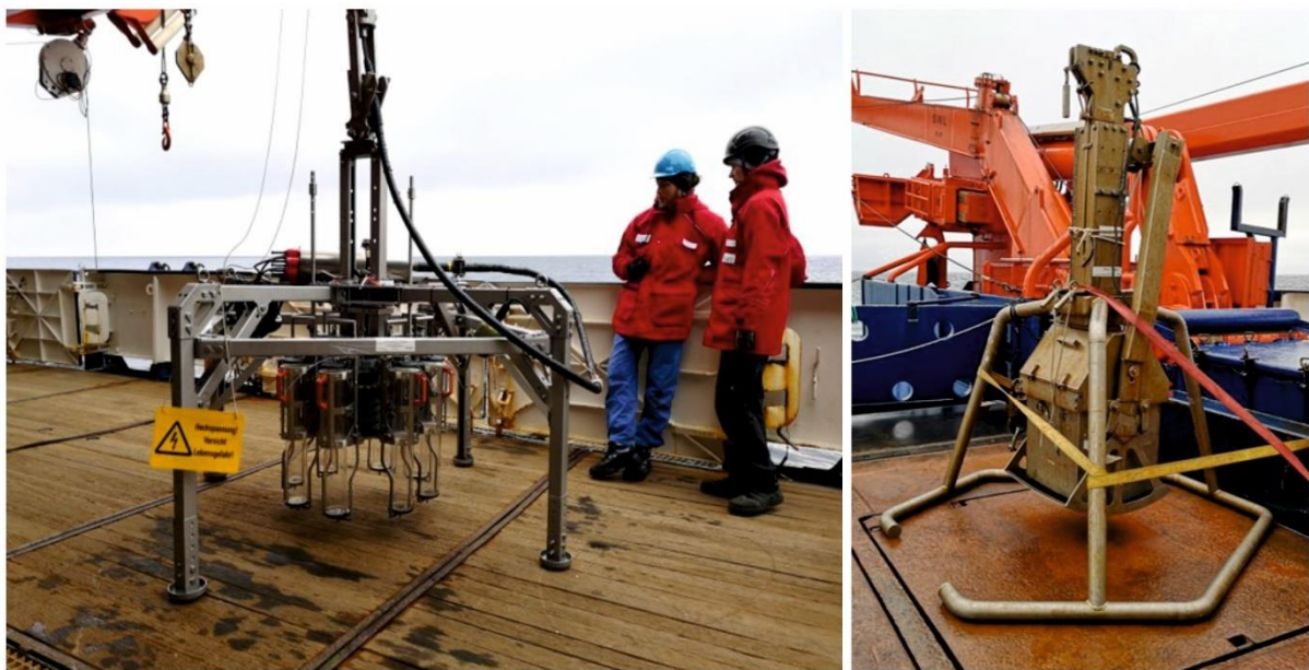
Abb. 9 Geräte zur Gewinnung von Sedimentproben: Der video-gesteuerte Multi-Corer (TV-MUC; links) und der USNEL Großkastengreifer (GKG; rechts).
