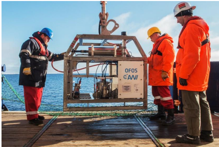
Abb. 8 Einsatz des Ocean Floor Observation Systems (OFOS) zur Gewinnung von Meeresbodenfotographien
