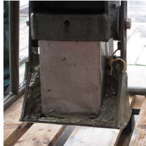
Beprobung des Oberflächensediments: der Kastengreifer beim Entladen (links) und mit Sediment an Deck (rechts)
