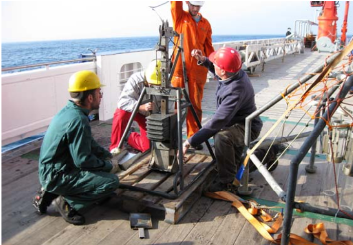
Beprobung des Oberflächensediments: der Kastengreifer beim Entladen (links) und mit Sediment an Deck (rechts)
