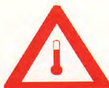
Kennzeichen für erwärmte Stoffe
