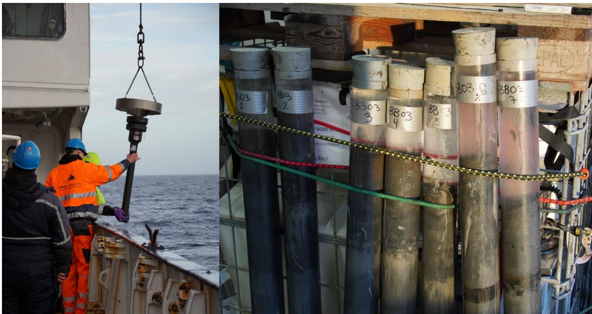
Gewinnung von Oberflächensedimentproben mit dem Rumohrlot (Foto: V. Mohrholz)
