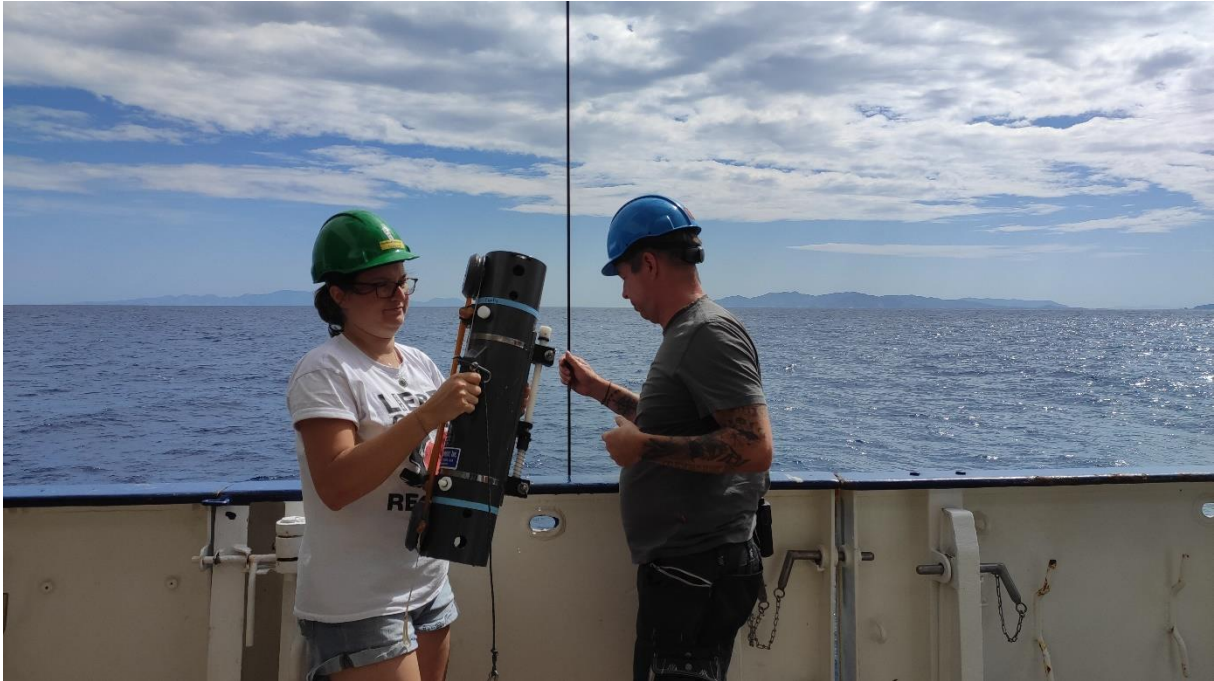
Abbildung 5: Eva Meckel (Constructor University) und Bootsmann Michael Zeigert setzen eine spurenmethallreine GoFlo-Flasche am Kevlar-Seil ein (Foto: Andrea Koschinsky)
