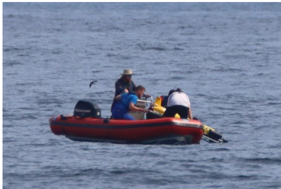
Abb. 4: Aussetzen des mit dem Underwater Vision Profiler bestückten Gleiters auf dem 11°S Schnitt.
