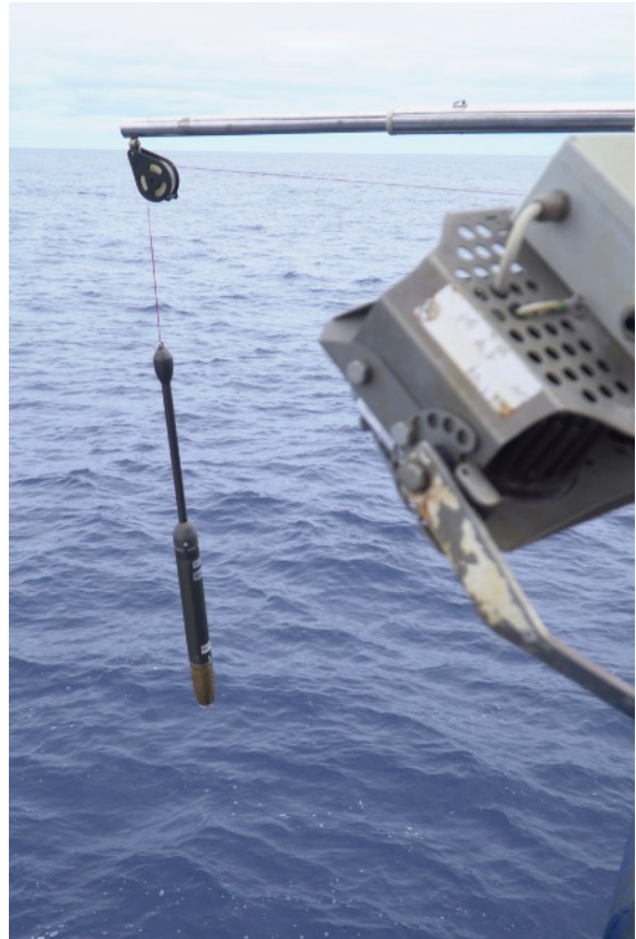
Abb. 1: Freifallende CTD-Sonde (underway CTD) zur Messung von Temperatur- und Salzgehaltsprofilen bei fahrendem Schiff (Foto: B. L. Duong).
