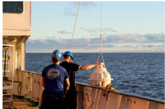
Abb.2: Verankerungsaufnahme mit einem ADCP in einer großen Auftriebskugel (oben links), und die akustischen Auslöser mit kleinen Auftriebskugeln (oben rechts). Unten: Bergung eines Inverted Echo Sounders (PIES). Alles bei besten Wetterbedingungen. (Fotos: A. Welsch und C. Mertens).
