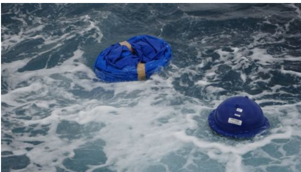
Abb. 4: Die zwei Typen von Driftern beim Aussetzen: Links SVP (Surface Velocity Project) Drifter mit einem Segel in 15 m Tiefe und rechts ein hauseigener hereon Drifter (Fotos: A. Welsch).
